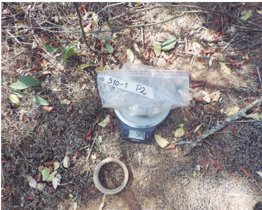
Figura 20. Pesaje de una muestra de suelo húmeda durante el trabajo de campo. Foto: CIPCA.
