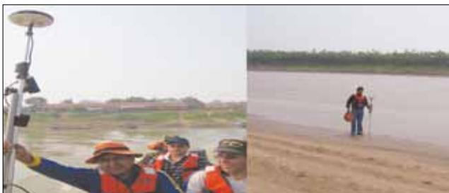
La sección transversal batimétrica fue complementada con taquimetría, que comprendió su medición desde el pelo de agua o línea de costa, hasta el punto más alto del barranco en los márgenes de río, que fue determinado con receptores DGPS Ashtech, con la modalidad cinemática para el posicionamiento de los sondeos en las secciones.
